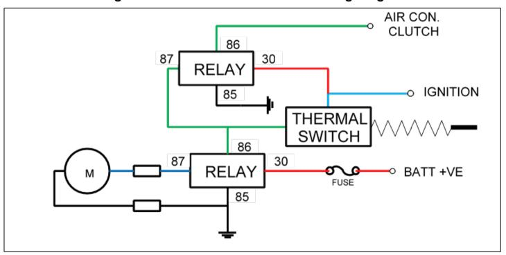
**Single Condenser Fan Wiring Diagram**
